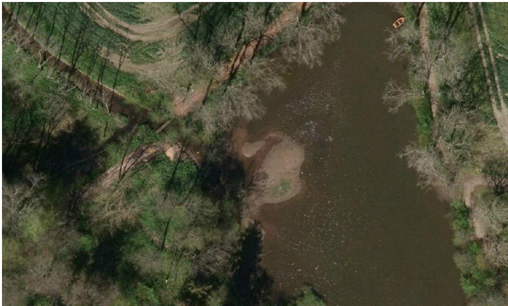
Billede 3: I selve voldstedet er der aflejret en større mængde sediment foran indløbet fra Margård Mølle Å.
